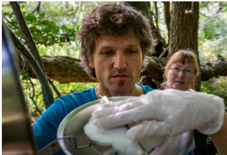
*Abbildung 7: Einlegen einer PUF-Scheibe in einen der Passivsammler, durchgeführt beim Aufbau durch Christine Vogt mit medizinischem Schutzhandschuh. Ebenfalls zu sehen sind Dr. Philip Bedall und Beate Blaby. Bild: Jörg Farys*
